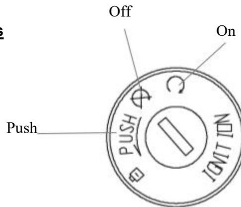
**ON:** Der Motor kann gestartet- und die Lichter eingeschaltet werden.
