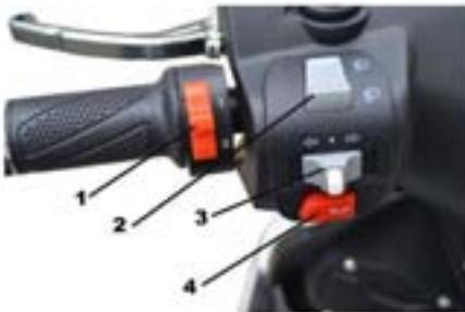
1. I Gang = ECO Modus (geringere Beschleunigung und höhere Reichweite, II Gang, schnellere Beschleunigung und geringere Reichweite)
