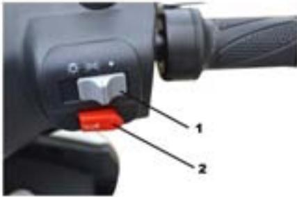
1. Licht ; rechte Position; Tagfahrlicht an, Mittige Position: alle Licht an, linke Position: Fernlicht an
