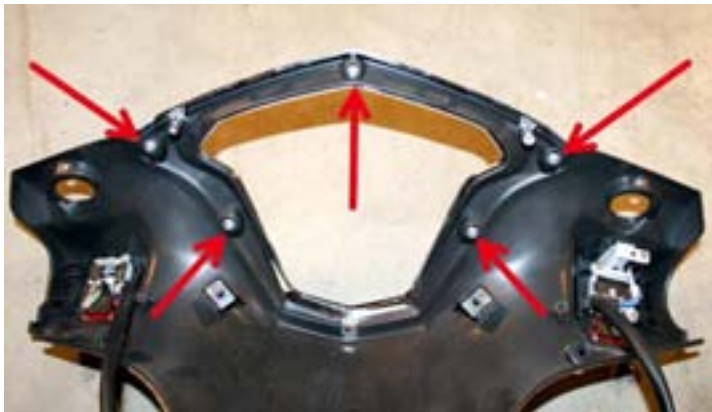
Abbildung 2-103 Schrauben herausdrehen und Tachorahmen entnehmen
