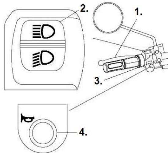
1. Linker Bremshebel: Drücken Sie beim Anhalten des Rollers die linke Bremse sanft und fest, um die Hinterradbremse zu betätigen. Betätigen Sie immer zuerst die Hinterradbremse.
