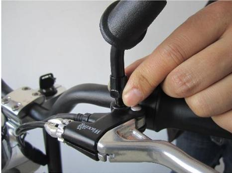
**5. Stellen Sie die Bremshebel so ein, dass diese bequem Betätigt werden können. Ziehen Sie anschließend die Schrauben fest.**
