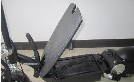
**6. Öffnen Sie das Batteriefach. Es befindet sich unter dem Trittbrett und klappen Sie das Fach nach oben.**
