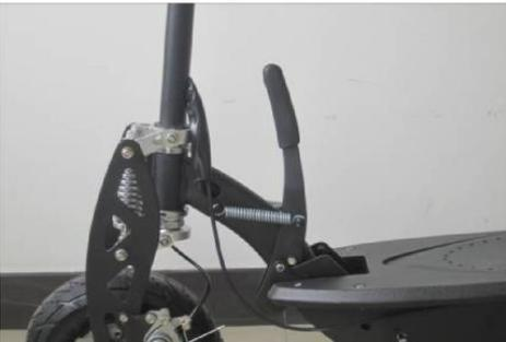
5. Justieren Sie die silberne Klammer am oberen Lenker. Stellen Sie sicher, dass der Gashebel sich auf der rechten Seite befindet und ziehen Sie dann die Schrauben mit einem Inbus Schlüssel fest.
