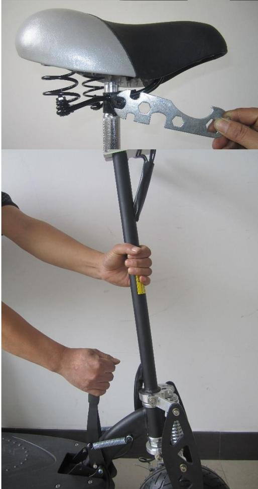
**11. Schrauben Sie den Sitz fest und ziehen Sie die schrauben mit dem mitgelieferten Werkzeug an**
