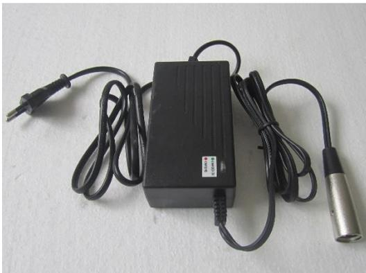
Nach dem einstecken leuchtet die LED am Ladegerät rot auf. Wenn der Roller vollständig geladen ist wechselt die LED von rot auf grün. Die Batterie ist nun vollständig geladen und das Ladegerät kann abgeklemmt werden.
