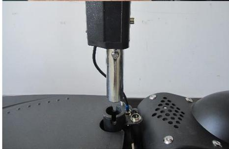
**8. Stecken Sie die Sitzstange in die dafür vorgesehene Öffnung ein und befestigen Sie diese mithilfe der mitgelieferten Schraube.**
