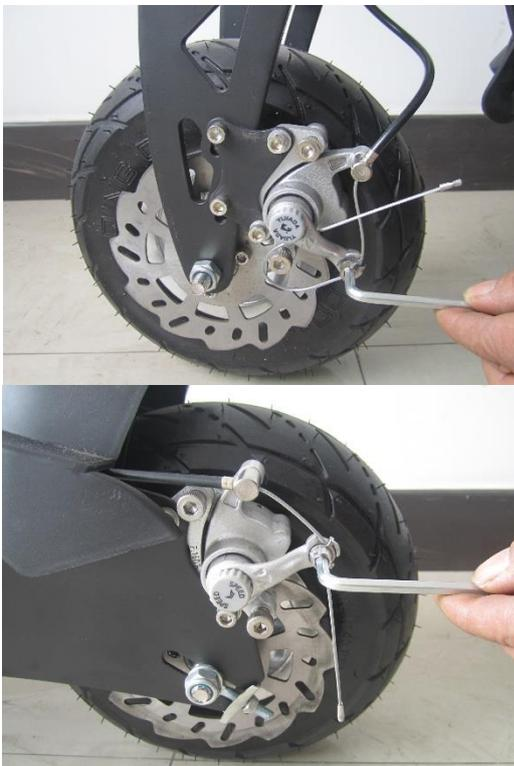
Lösen Sie die Schraube am Bremssattel (links am Rad) und ziehen am Bremszug bis dieser ausreichend gespannt ist.
