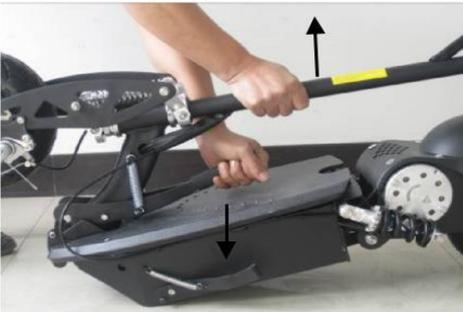
2. Um den Roller aufzuklappen drücken Sie mit einer Hand den Hebel nach unten und ziehen Sie mit der anderen die Lenkstange nach oben, bis diese einrastet.
