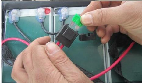
**7. Setzen Sie die 30 Ampere Sicherung in den dafür vorgesehenen Halter ein und schließen den Deckel**
