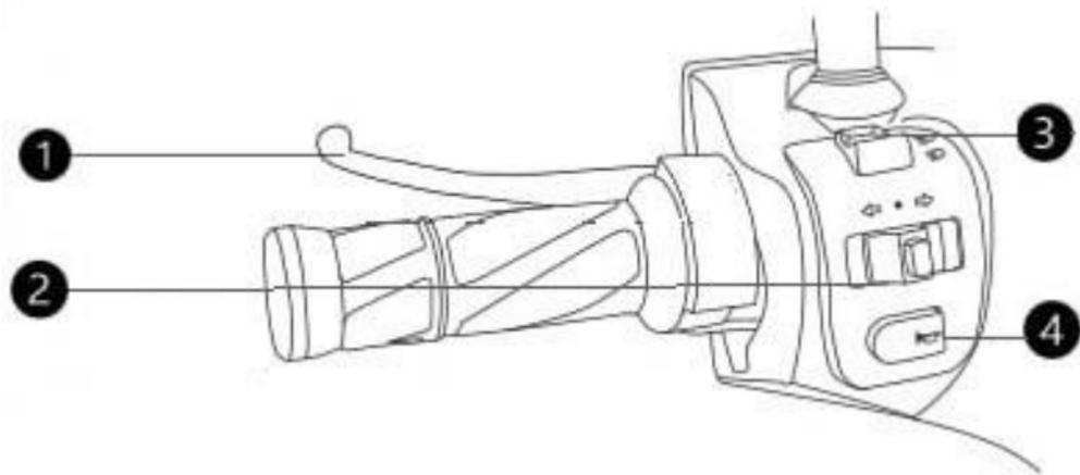
1. Linker Bremshebel: Drücken Sie beim Anhalten des Rollers die linke Bremse sanft und fest, um die Hinterradbremse zu betätigen. Betätigen Sie immer zuerst die Hinterradbremse.
