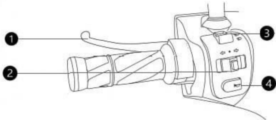
1. Linker Bremshebel: Drücken Sie beim Anhalten des Rollers die linke Bremse sanft und fest, um die Hinterradbremse zu betätigen. Betätigen Sie immer zuerst die Hinterradbremse.
