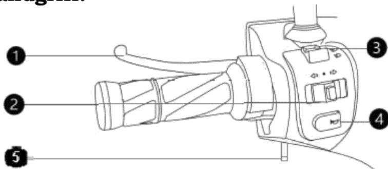
1. Linker Bremshebel: Drücken Sie beim Anhalten des Rollers die linke Bremse sanft um die Hinterradbremse zu betätigen. Betätigen Sie immer zuerst die Hinterradbremse.
