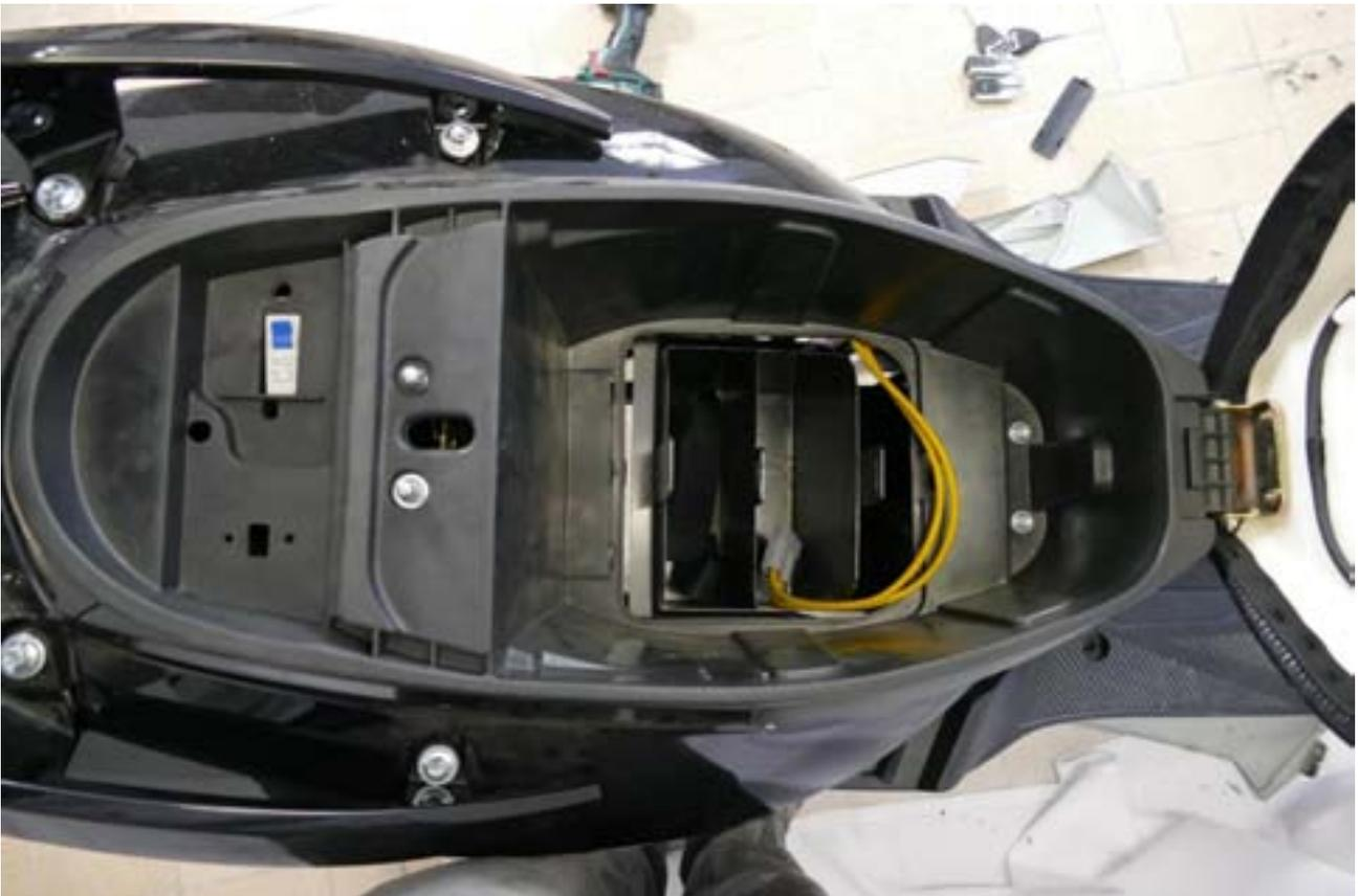
2.10 Front unter dem Sitz mit Ladeanschluss entfernen
