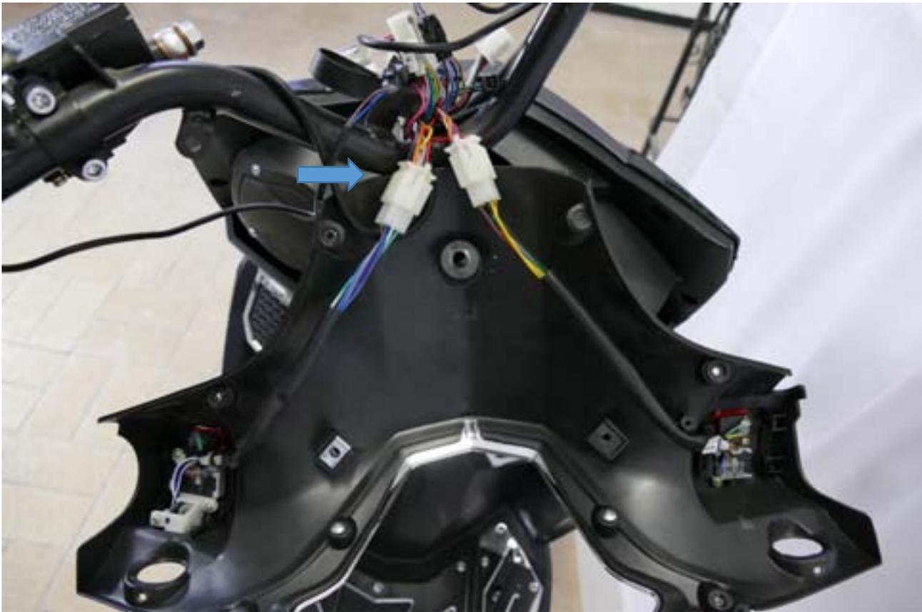
1.11 Bedienelementleiste links (Fernlichtschalter, Schalter Hupe links) wechseln
