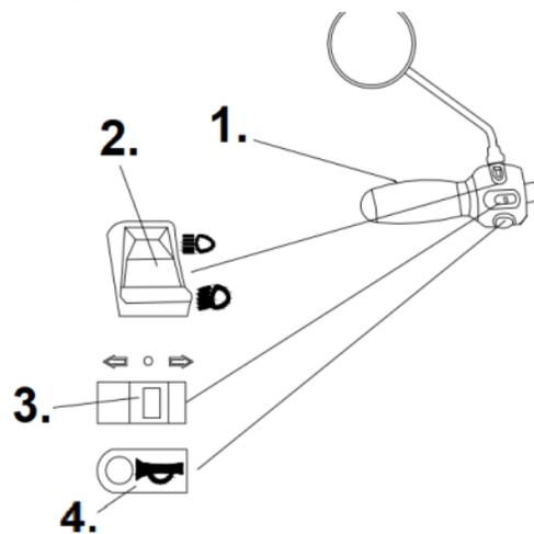
1. Linker Bremshebel: Drücken Sie beim Anhalten des Rollers die linke Bremse sanft und fest, um die Hinterradbremse zu betätigen. Betätigen Sie immer zuerst die Hinterradbremse.
