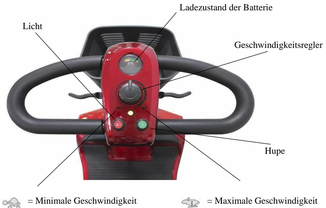
Die Höchstgeschwindigkeit Ihres Elektromobils kann mit Hilfe des Geschwindigkeitsreglers (siehe Bild) variabel eingestellt werden. Um die gewünschte Höchstgeschwindigkeit zu erreichen, drücken Sie die Fahrwippe so weit wie es möglich ist nach vorne.
