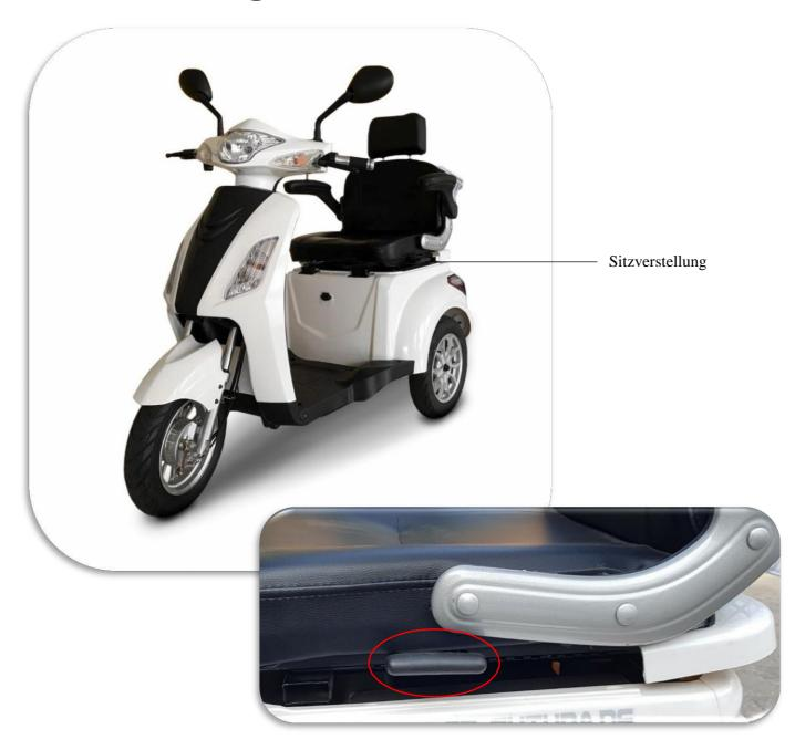
Der Sitz ist einstellbar. Ziehen Sie dafür am Einstellhebel. Dieser befindet sich auf der rechten Seite unterhalb des Sitzes. Verschieben Sie anschließend bei gezogenem Hebel den Sitz in die gewünschte Position.
