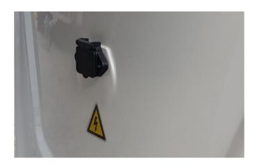
Die Ladebuchse befindet sich unterhalb der Sitzbank. Schließen Sie das mitgelieferte Ladegerät an die Ladebuchse am Trike und an eine 220V Netzsteckdose an.
