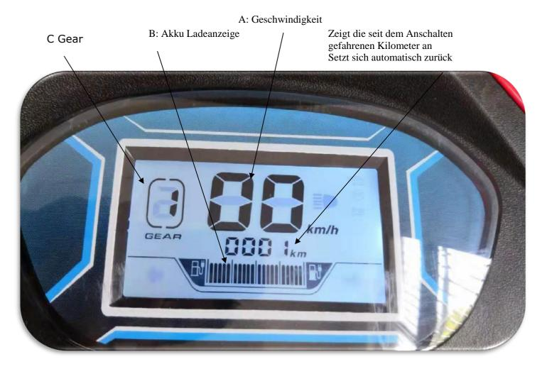
A: Die Geschwindigkeitsanzeige zeigt an, wie schnell Sie sich fortbewegen. Achten Sie darauf, dass Sie den Wetterverhältnissen entsprechend und vorsichtig fahren. Außerdem muss vor Kurven unbedingt die Geschwindigkeit reduziert werden, da die Gefahr besteht, in den Kurven umzukippen
