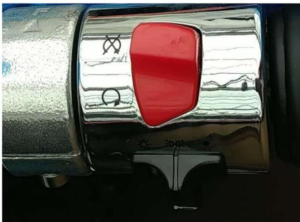
Der Stromkreisschalter muss zum Fahren in die Position wie in der Abbildung geschaltet werden, da sonst der Stromkreislauf unterbrochen ist (siehe Abbildung)
