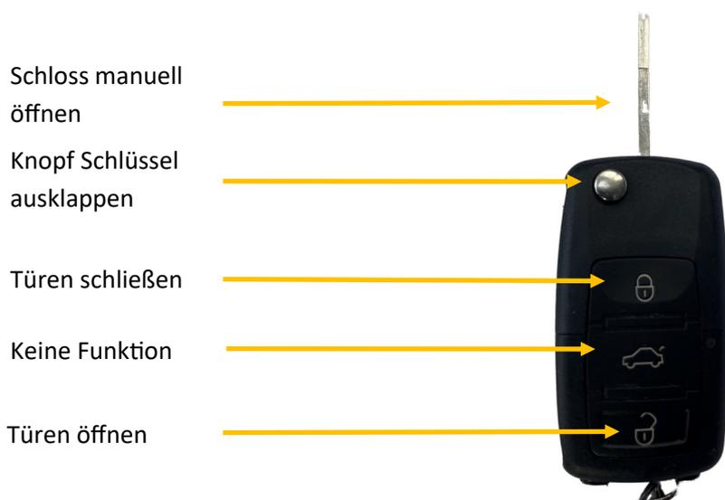
Das Öffnen der Türen mit der Fernbedienung kann nur bei eingeschalteter Hauptsicherung erfolgen !
