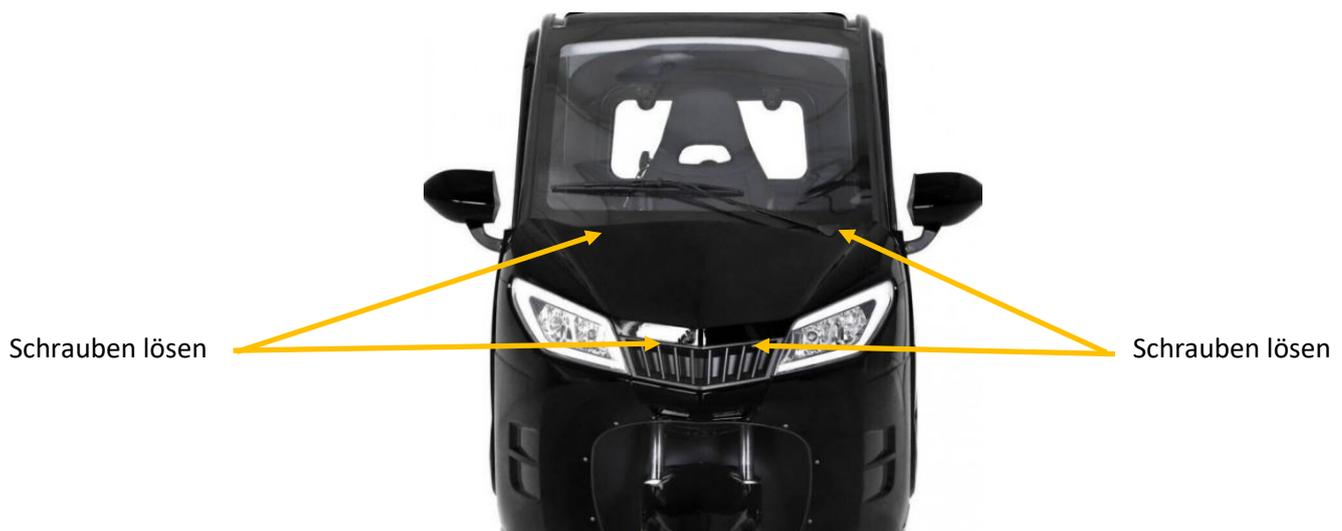
Unter der „Motorhaube“ finden Sie die Steckverbindung zum Drosseln/Entdrosseln des Kabinenrollers.
