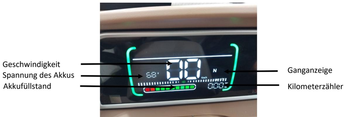
Beim Einschalten des Fahrzeugs zeigt das Tachodisplay für mehrere Sekunden den Gesamtkilometerstand an und springt danach automatisch zum „Trip-Kilometerzähler“. Der Trip-Kilometerzähler misst die gefahrene Strecke nach dem letzten Einschalten des Rollers.
