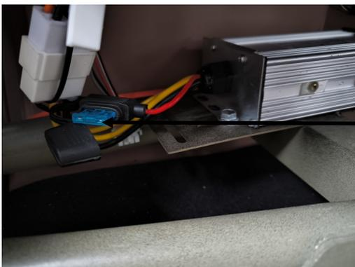
Der Converter verfügt über eine zusätzliche Sicherung
