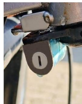
Das Lenkradschloss dient zur Diebstahlsicherung. Zur Fixierung des Lenkers bringen Sie diesen bitte in eine mitte-links Position und schließen Sie sodann das Schloss. Der Lenker ist somit arretiert.
