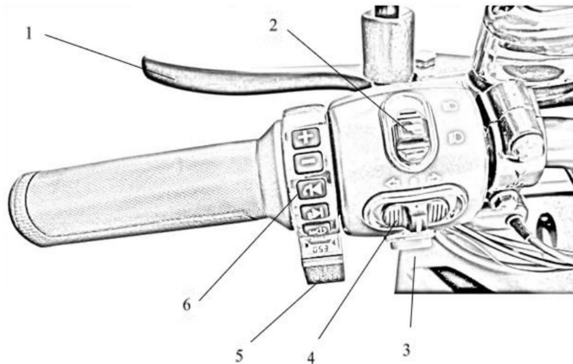
1. Linker Bremshebel: Drücken Sie beim Anhalten des Rollers die linke Bremse sanft und fest, um die Hinterradbremse zu betätigen. Betätigen Sie immer zuerst die Hinterradbremse.
