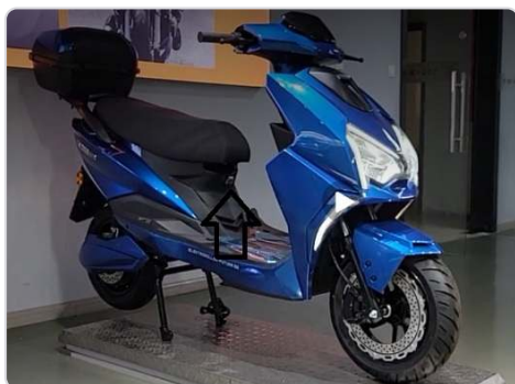
Der Pfeil zeigt auf die Ladebuchse vorn unter der Sitzbank
