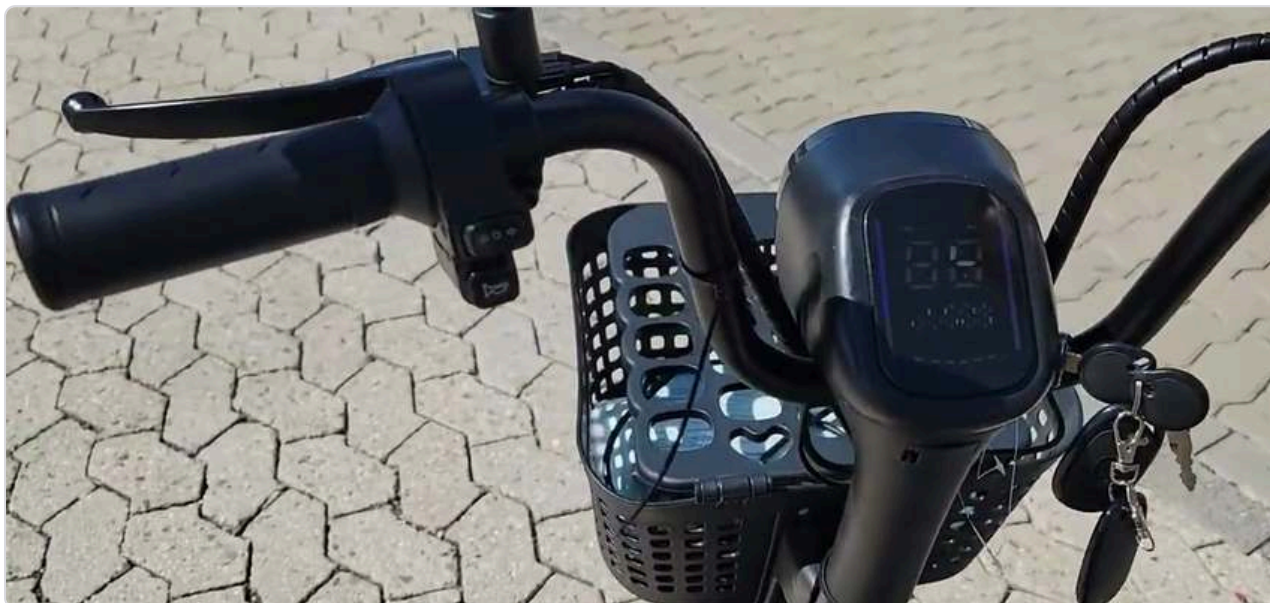
Lenker mit Schaltereinheit links, Display in der Mitte und Zündschloss rechts daneben
