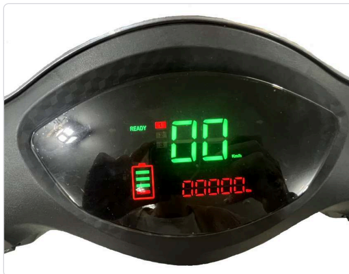
Display: Geschwindigkeit (groß), Fahrstufe, Akkufüllstand und Kilometerstand
