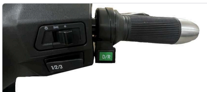
Bedienelemente rechts: Lichtschalter, Fahrstufenschalter „1/2/3“, Taste „D/R“ und Gasgriff
