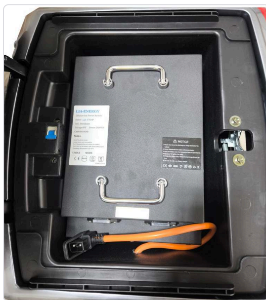
Zum Herausnehmen die orange Steckverbindung auseinanderziehen
