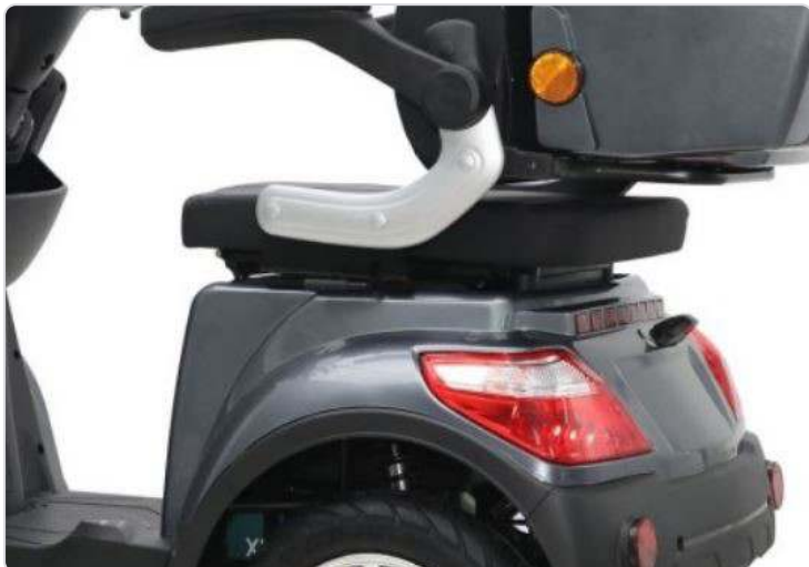
Hebel zum Verstellen der Rückenlehne und Position der Gurtbefestigung
