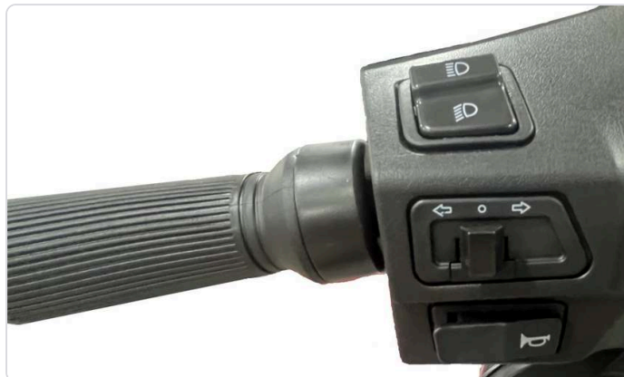
Bedienelemente links: oben Fernlicht, Mitte Blinker, unten Hupe
