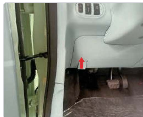
Entriegelungshebel im Fahrerfußraum links
