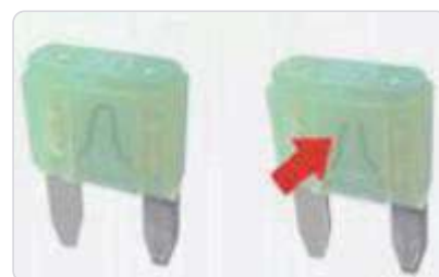
Links: intakte Sicherung · rechts: durchgebrannte Sicherung (Pfeil: unterbrochener Schmelzleiter)
