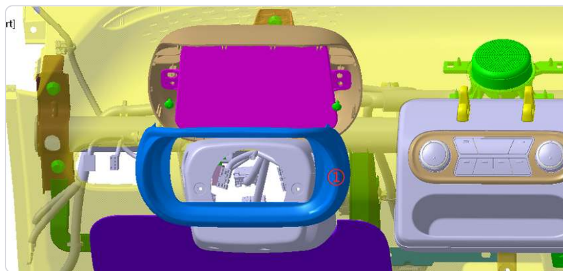
Ausbau des Kombiinstrumentes: 1 obere Abdeckung des Kombiinstrumentes
