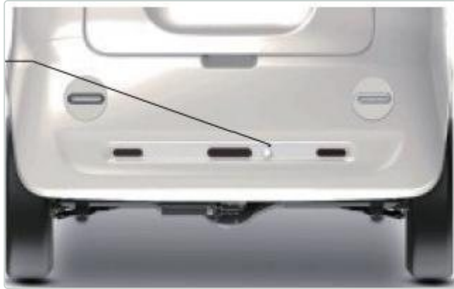
Lage der HD-Kamera am Heckstoßfänger.
