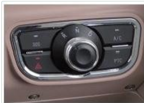
Mittelkonsole: Fahrstufen R N D sowie die Tasten A/C (Kaltluft) und PTC (Heizung).
