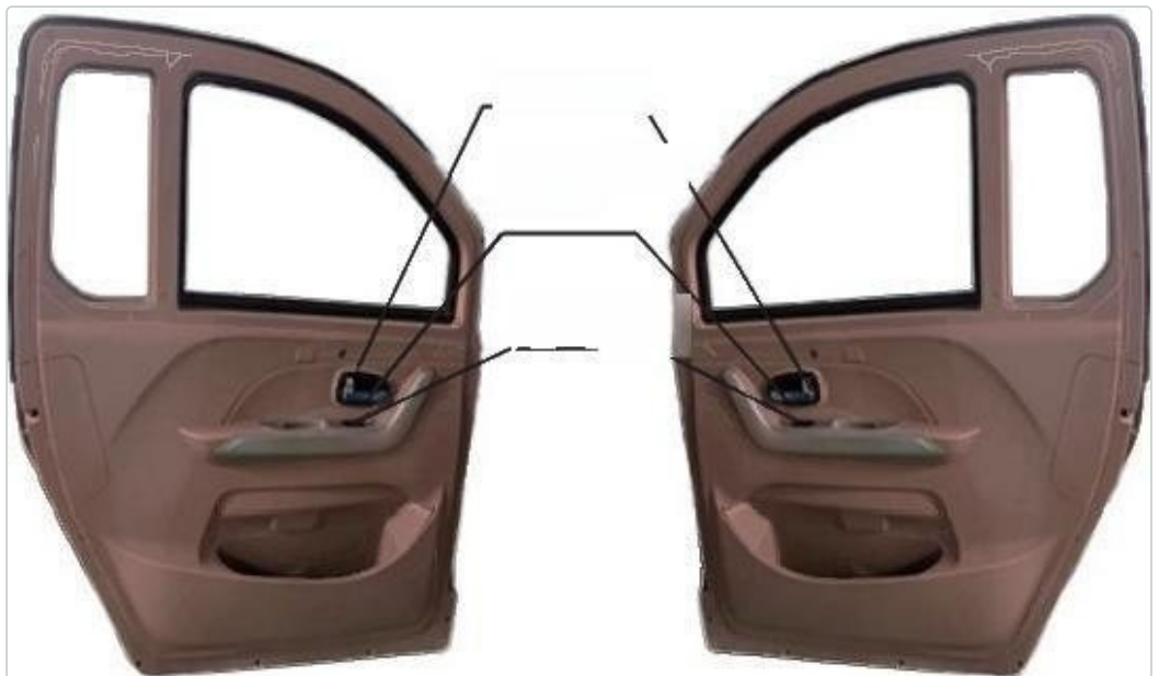
Türinnenseiten mit Fensterheberschalter und manueller Verriegelung.
