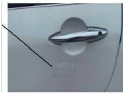
NFC-Sensorfläche hinter der linken Tür.
